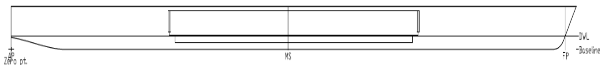
SLIKA 2. LATERALNA POVRŠINA A=468\text{ m}^2 PONTONA SA PRIVEZOM PUTNIČKOG BRODA OD 135M
